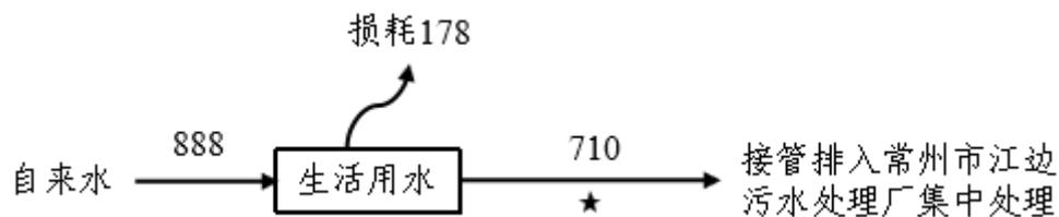
图 2-1 本项目水量及水平衡图 (t/a)
