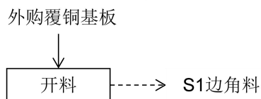
图3-4 开料工序工艺流程图
