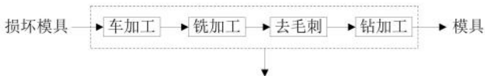
图 2-2 模具维修工艺流程图
