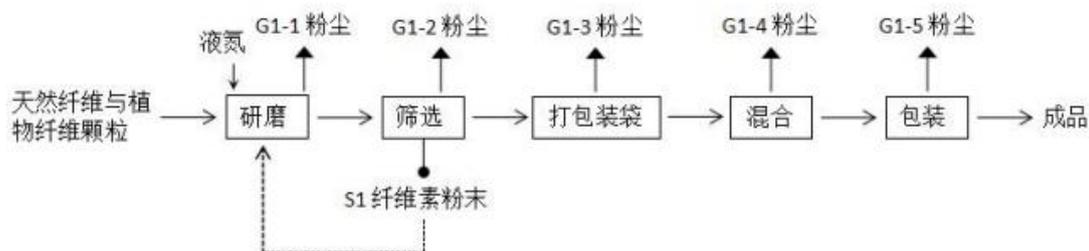
图 2-3 天然纤维及植物纤维提取及加工工艺流程图
