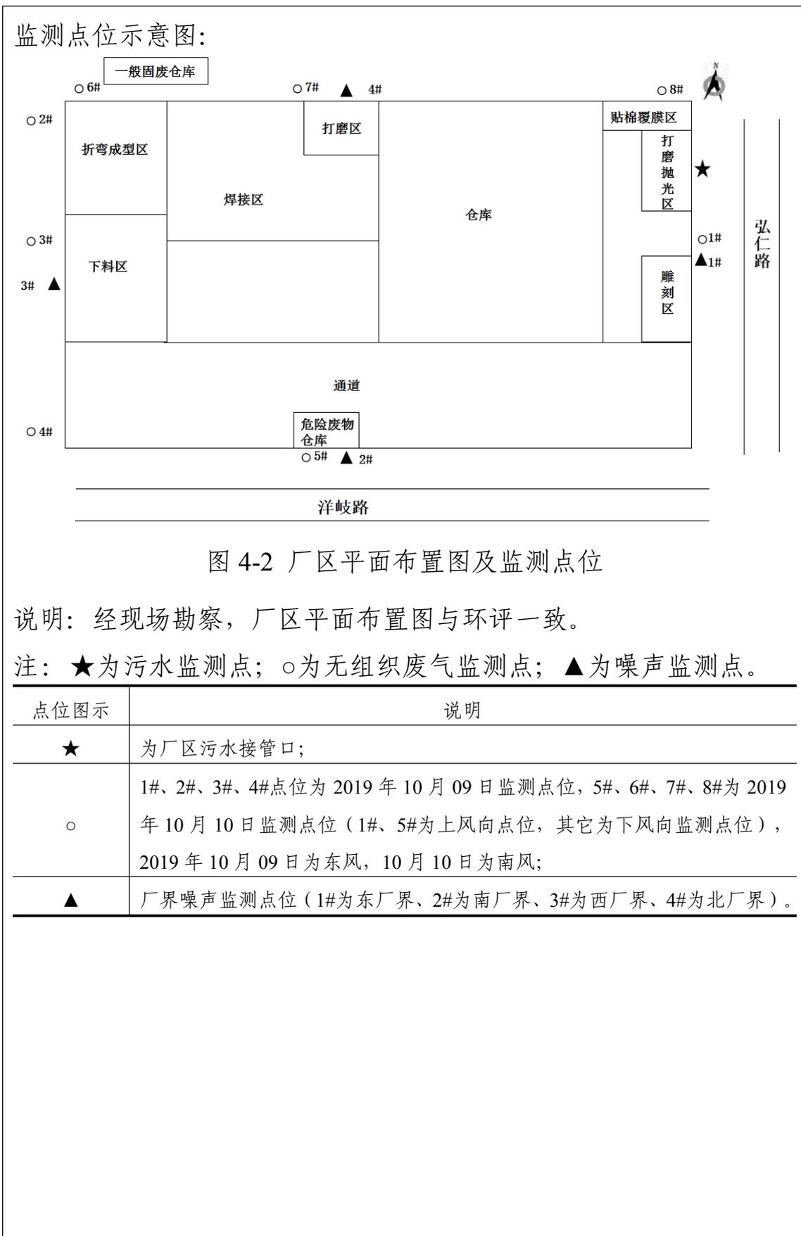
图 4-2 厂区平面布置图及监测点位
